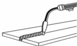
Рисунок 20. Сварка в нижнем положении
