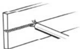
Рисунок 13. Горизонтальное положение при сварке
