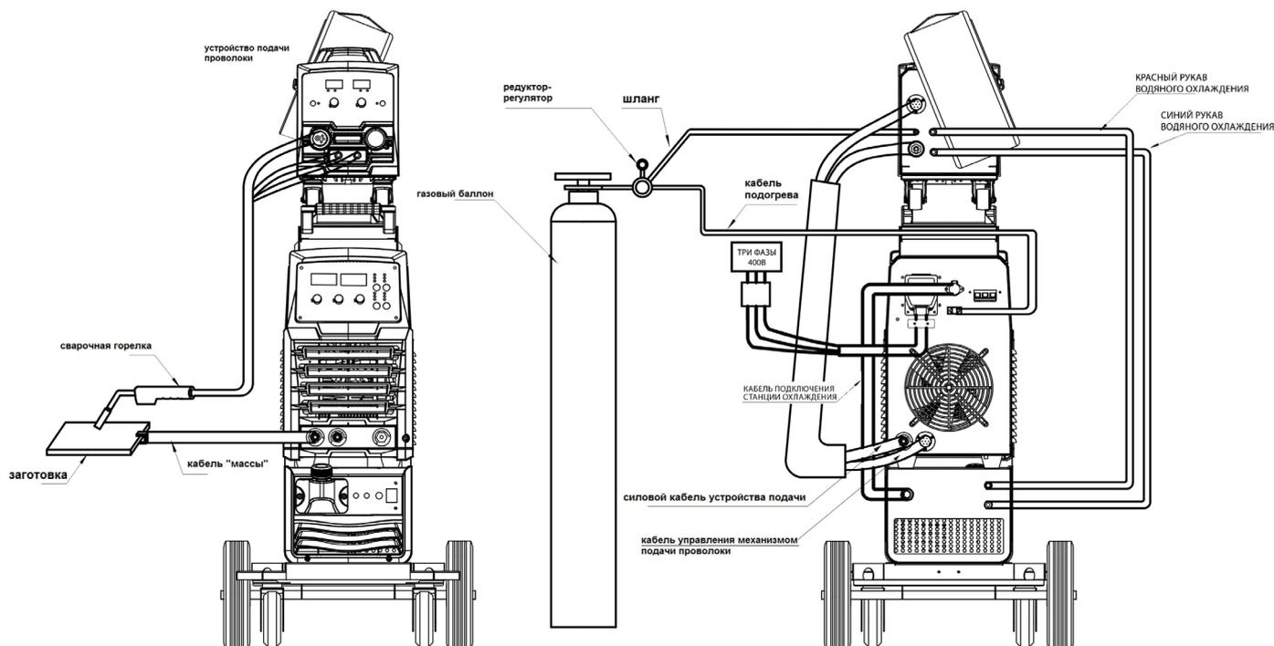
Рис. 6. Схема подключения для работы в режиме MIG.
