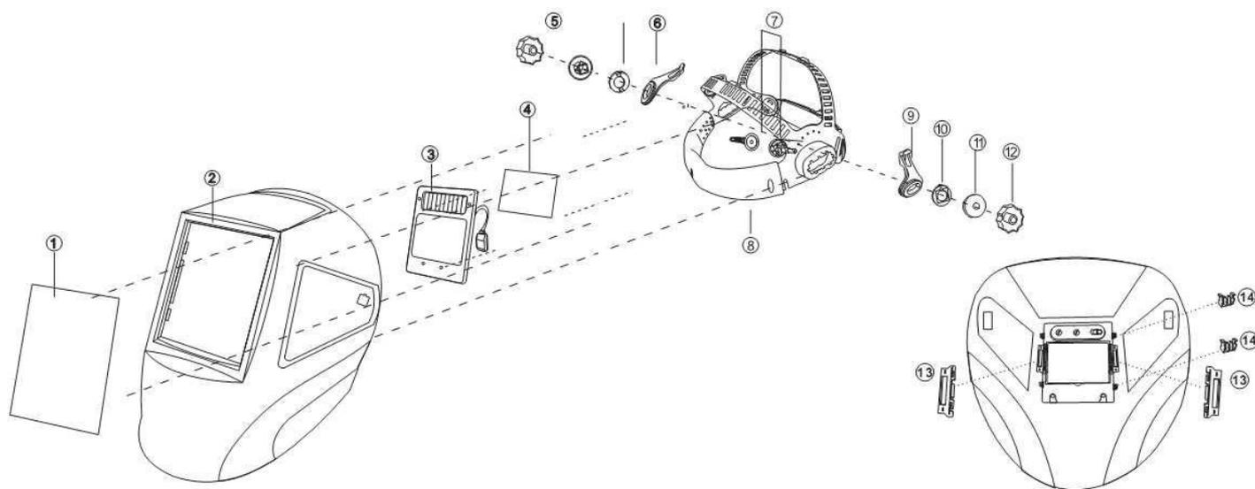
(1) Внешнее поликарбонатное защитное стекло (2) Щиток (сварочная маска) (3) Автоматический светофильтр (4) Внутреннее поликарбонатное защитное стекло (5) (10) (11) (12) Гайки и шайбы крепления оголовья (6) (9) Крепление оголовья и механизма установки угла опускания маски (7) Винт крепления оголовья (8) Оголовье маски (13) Крепление линз (опционально, в комплект поставки не входят) (14) Крепления-фиксаторы светофильтра
